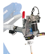
溶接トーチ取付状態と 補正装置
