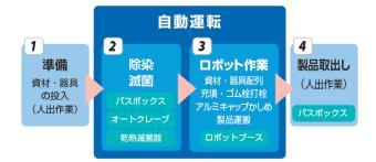
双腕ロボット MOTOMAN-CSDA10F (可搬重量10Kg/腕)を使用し、 バイアル瓶、ゴム栓、アルミキャップ などの減菌器への投入・取出し、充填 作業・キャッピングを行います。
